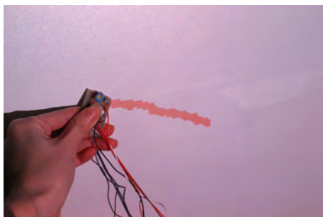
図 8 受光器をマウスのように使い、投影面上でPCの操作をする様子
